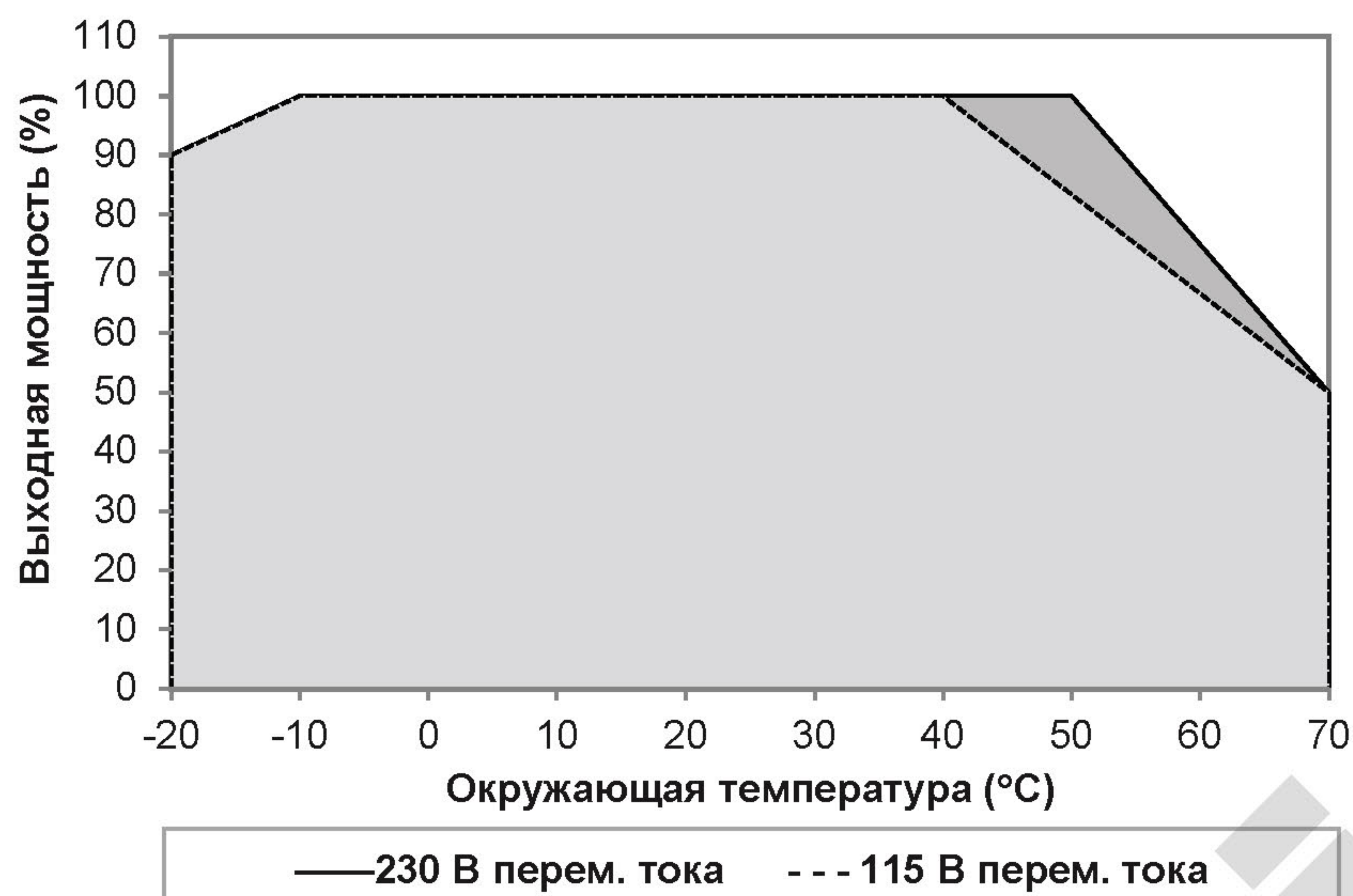
Рис. 1 Снижение мощности в зависимости от температуры -20°C ... -10°C снижение мощности 1% / °C > 40°C снижение мощности 1.67% / °C @ 115Vac > 50°C снижение мощности 2.5% / °C @ 230Vac
